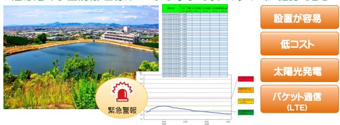
溜め池の水位データをリアルタイムに遠隔監視するシステムです。
